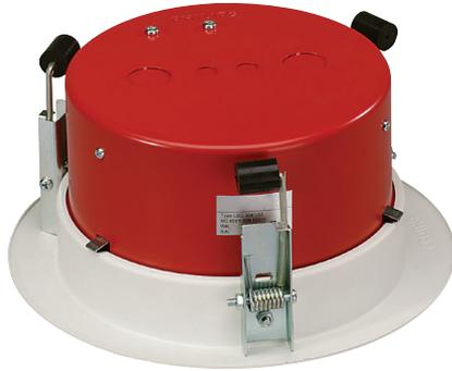
在发生火灾时，安装扬声器的天花板开孔会使火焰在整个建筑特内蔓延。为了防止火焰通过扬声器进入孔隙，天花扬声器可以安装钢质防火罩 (LBC 3081/02)。在安装扬声器之前，这一可选防火罩通过三个板簧卡入到安装环中。为了提供额外方便，防火罩的安全索允许安装人员在安装期间暂时悬挂扬声器。此外，在完成安装后，此安全索还可以提供额外的安全保护。防火罩设有用于安装两个垫圈 ( 随附 ) 和两个电缆密封塞 ( PG 13 ) 的开孔。这款防火罩只能与 LBC 3086/41 天花扬声器配合使用。
