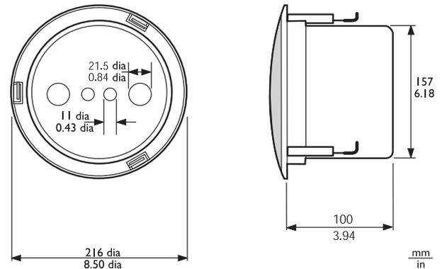
LBC 3086/41 + LBC 3081/02 防火罩组件尺寸 ( 单位 : 毫米 [ 英寸 ] )
